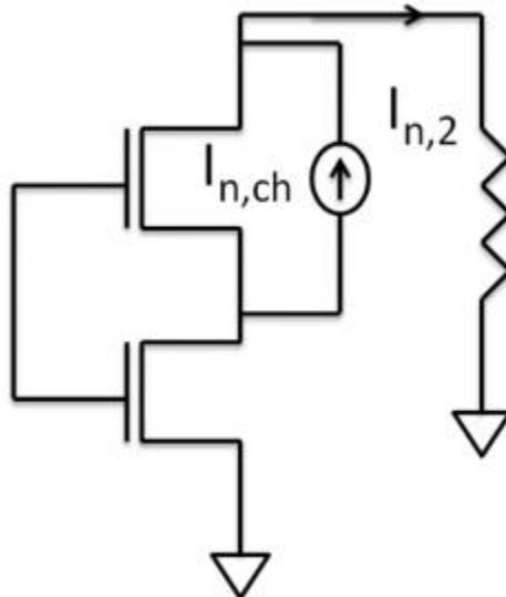
$$I_{n1} \cong I_{n,h} \frac{g_{m,ch} + g_{d,ch}}{g_{m,ch} + g_{d,ch} + g_{d,h}}$$
